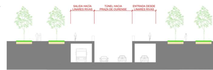
Sección salida túnel hacia Praza de Ourense
