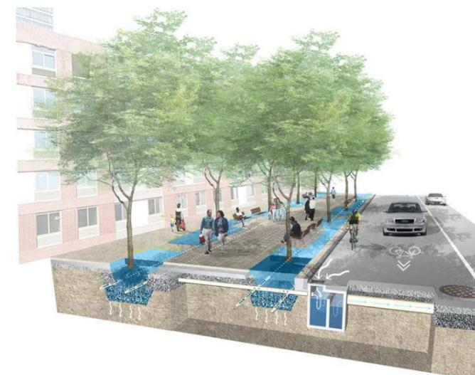
Fig. 141. Sección de calle con integración de técnicas SUDS.
