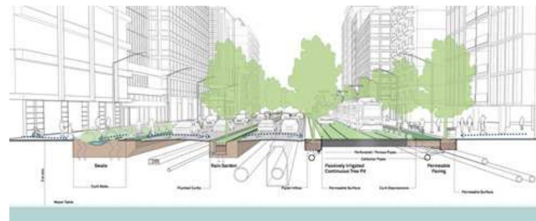
Fig. 142. Sección de calle con integración de técnicas SUDS.
